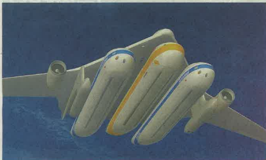
Clip-Air, concept de transport aérien de l'EPFL révolutionne l'idée qu'on se fait d'un avion. Des capsules de passagers se cliperaient sous une aile de pilotage. SP-EPFL
